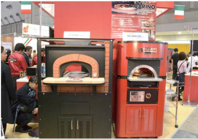
ガス式煉化石窯、ガス式ピッツァ窯（奥火型）
